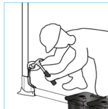
4 - À l'aide d'un marteau bloquer le coin entre le montant et l'embase.
